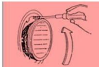
Dengan baut penyetel yang terletak di samping, kita stel lampu ke kanan/ ke kiri
